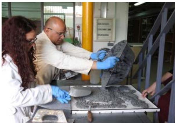
Figura 6. Elaboración de una placa de caucho-cemento. Fuente propia
