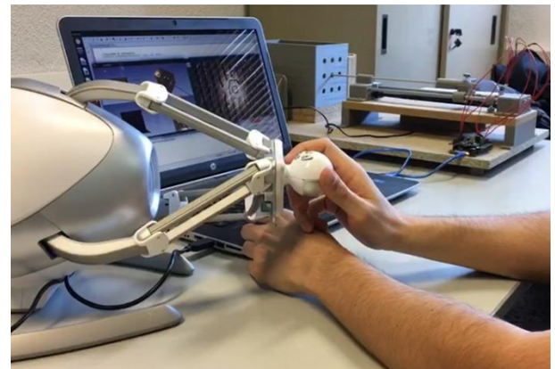
Figura 3. Novint Falcon, en primer plano, con el sistema robótico y el phantom en segundo plano.
