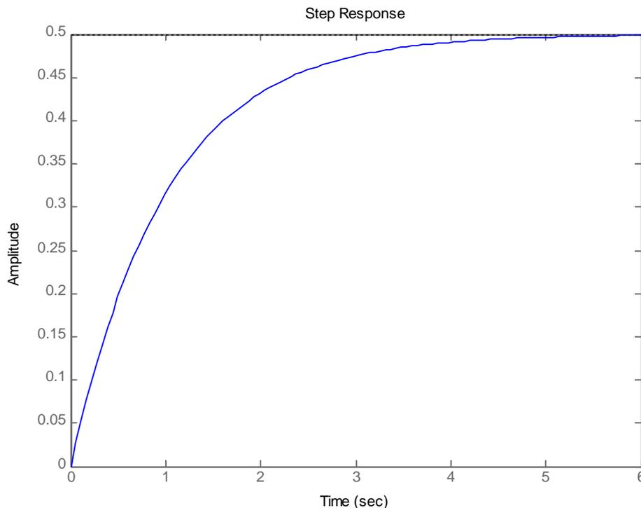
Que si la comparamos con la entrada al escalón apreciamos que hay una diferencia de 0.5 V en el régimen permanente, lo que corresponde al error en régimen permanente. Si calculamos éste error mediante el teorema del valor final aplicado sobre la señal de entrada  $e(t)$ , podremos relacionarlo con la ganancia del circuito de primer orden para poder calcularla:
