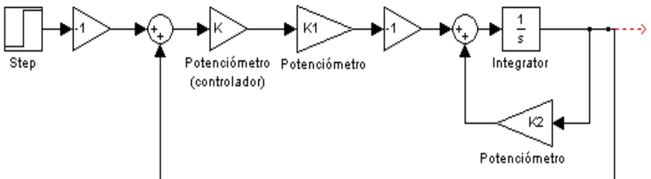
Si llamamos  $r(t)$  a la señal de entrada que vamos a introducir nosotros (el escalón),  $y(t)$  a la salida y  $e(t)$  a la entrada al circuito de primer orden con su controlador  $K$ , podemos deducir la función de transferencia de éste nuevo circuito realimentado con un controlador proporcional de ganancia  $K=1$ . Partiendo de éstas dos ecuaciones:
