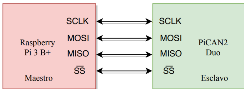
Figura 2.1: Esquema de la comunicación SPI entre Raspberry Pi y PiCAN2 Duo.
