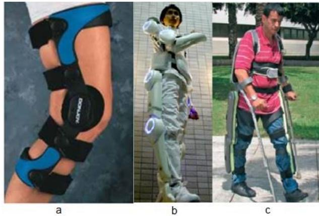
Figura 6. Órtesis pasiva (a) y activas (b, c).
