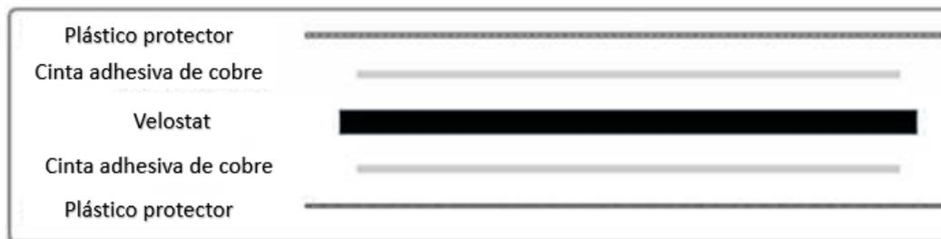
Figura 24. Distribución de capas del sensor.
