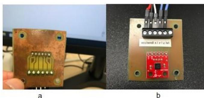
Figura 16. Acelerómetro sobre la PCB. Reverso (a) y anverso (b).
