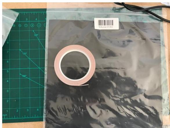
Figura 23. *Velostat* y cinta de cobre conductor adhesiva.
