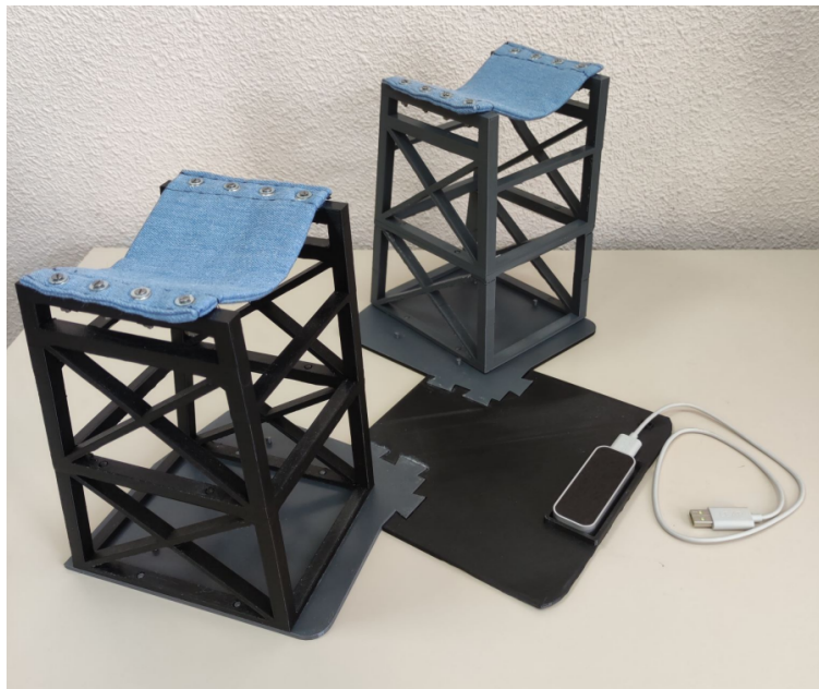
Figura 12: Soporte de manos impreso 3D para la correcta colocación de las manos por parte de los pacientes [28] .
