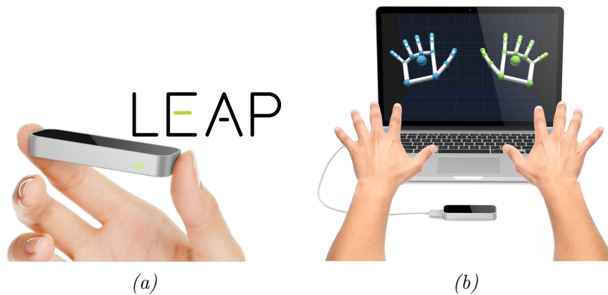
Figura 10: Dispositivo Leap Motion: (a) tamaño del dispositivo y (b) visualización de las manos virtuales captadas en un ejercicio real [25].
