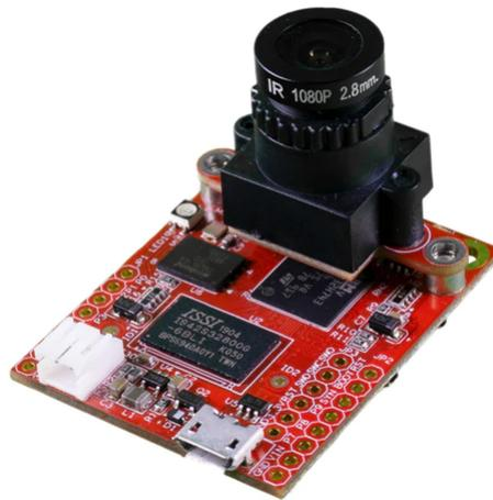
Figura 2.2: Sensor *OpenMV Cam H7 Plus*.
