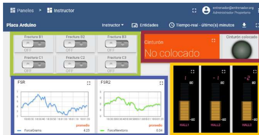
Figura B.6: Panel de visualización 1. En verde, los botones para generar las fracturas; en azul, los gráficos de visualización para los sensores FSR; en amarillo, los medidores del flujo magnético de los sensores Hall; y en rojo los indicadores de cinturón colocado.
