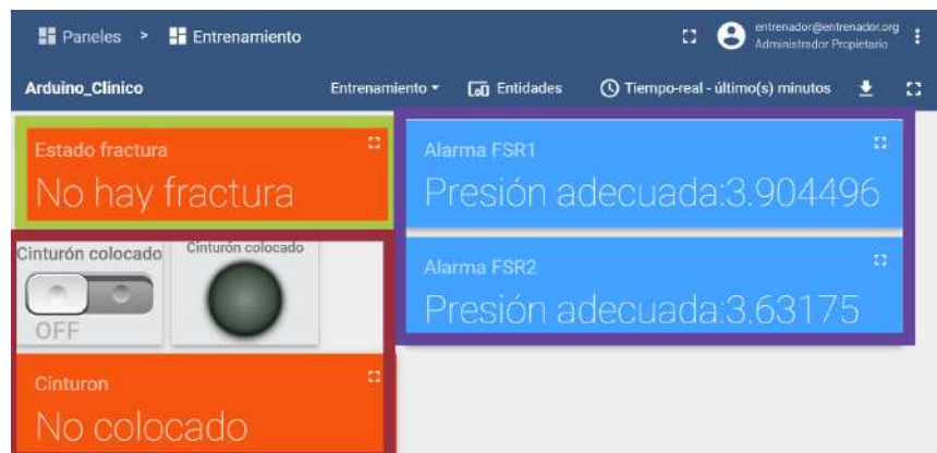
Figura B.7: Panel de visualización 2. En verde, el display indicador del estado de la fractura; en rojo el botón para indicar la colocación del estabilizador así como el display y led indicador; y en morado las alarmas que notifican el exceso de presión aplicado.
