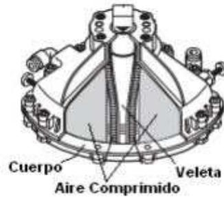
(c) Partes de un actuador neumático
