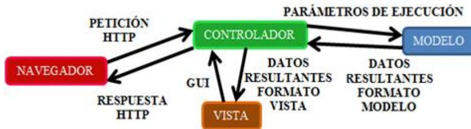
Figura 27 Interacciones en una arquitectura Modelo-Vista-Controllador
