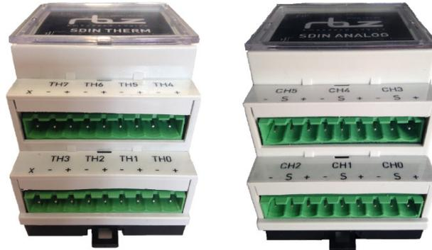
Figura 2.5: Plataformas *SDIN\_Therm* y *SDIN\_Analog*.
