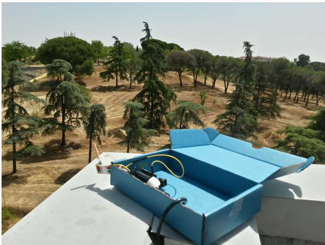
Figura 40. Dispositivo maestro conformado por sistema embebido Arduino Uno, transceiver SX1278 y batería de 5V en la terraza del edificio C de la ETSIT
