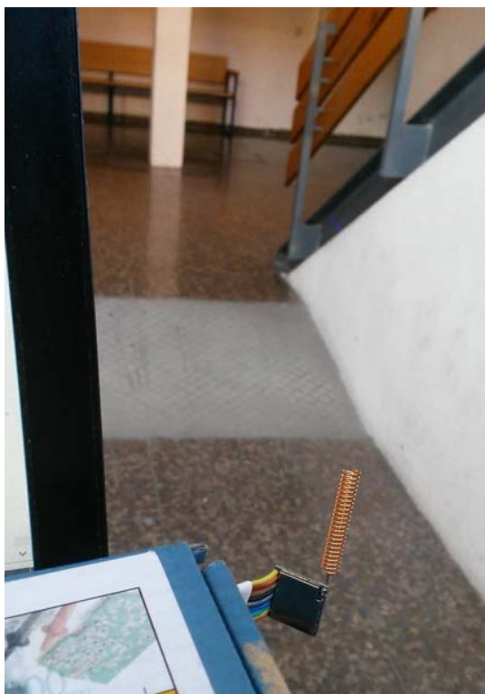
Figura 38. Dispositivo esclavo conformado por sistema embebido Arduino Uno y transceiver SX1278 en sótano del edificio A de la ETSIT
