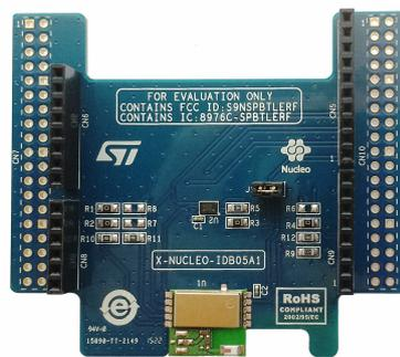
Figura 3.10: Módulo de expansión X-NUCLEO-IDB05A1[38].
