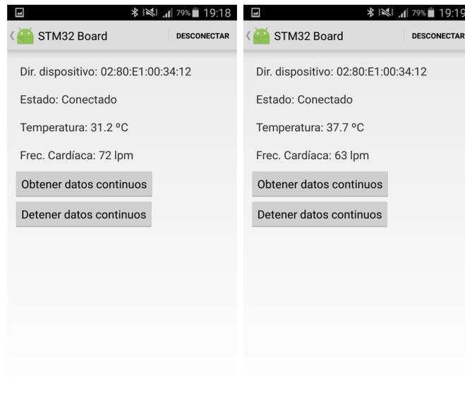
Figura 3.36: Capturas de DataShowActivity cuando se toman medidas del sensor de frecuencia cardíaca (izda) y del sensor de temperatura (drcha).
