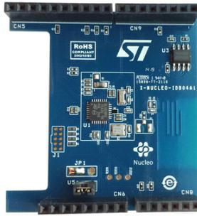
Figura 3.9: Módulo de expansión X-NUCLEO-IDB04A1[37].
