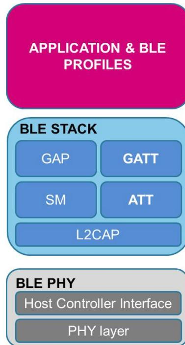
Figura 3.5: Pila de protocolos de BLE[34].
