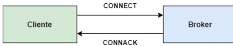
Ilustración 23 MQTT Conexión.
