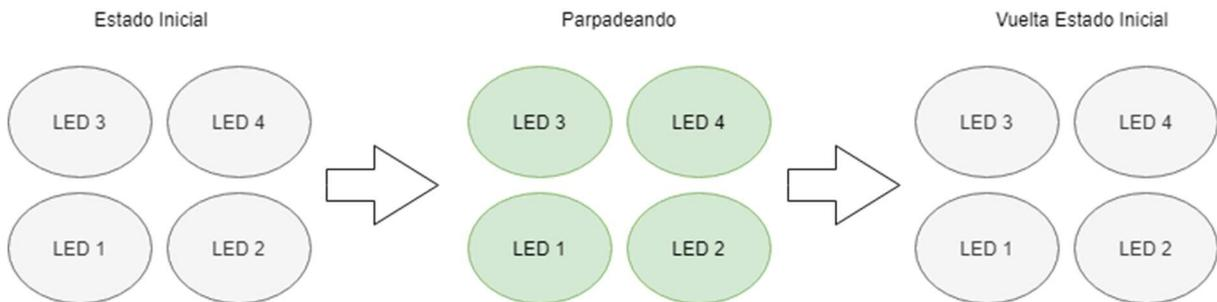
Ilustración 14 Leds estado error.
