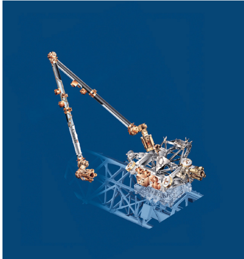
Figura 2.5: Canadarm2 unido al Mobile Base System.
